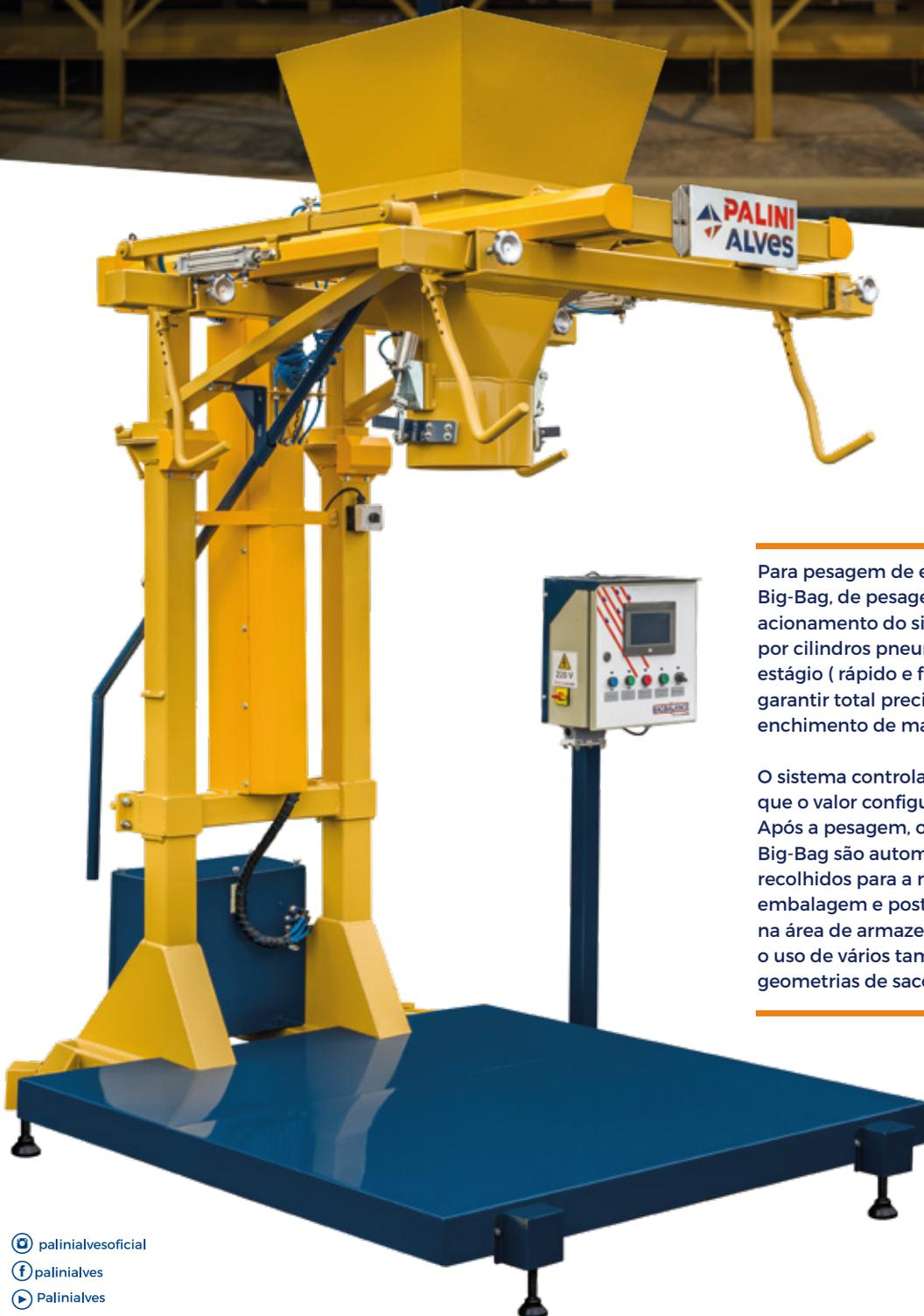
Para pesagem de embalagens tipo Big-Bag, de pesagem descendente com acionamento do sistema de alimentação por cilindros pneumáticos em duplo estágio (rápido e finalização lenta) para garantir total precisão no ciclo de enchimento de materiais a granel.
